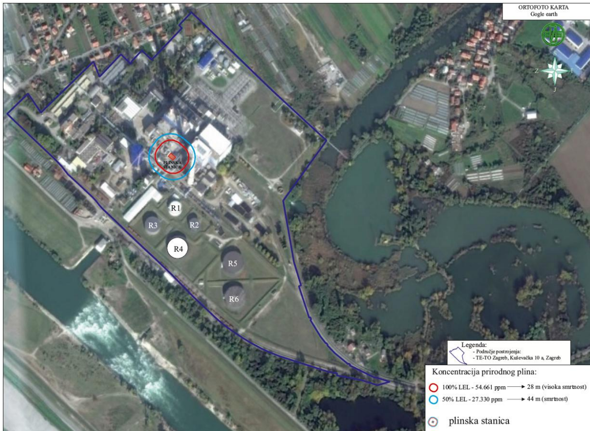
Slika 7 Zone ugrožavanja eksplozivnom koncentracijom prirodnog plina
